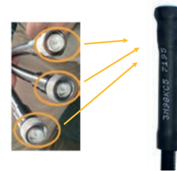
Diamètre utile sur bague 33mm Diamètre après rétreint <10mm
