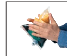
Mélanger environ 2 minutes pour obtenir un mélange parfaitement uniforme de couleur verte
