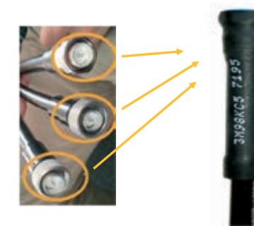
Diamètre utile sur bague 33mm Diamètre après retreint <10mm
